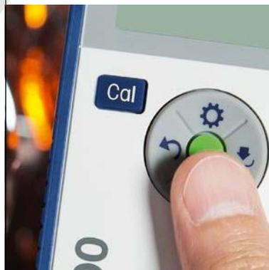
Los nuevos botones hardkey con disco de control de Seven2Go con tecnología de clic mejoran la velocidad de navegación por los menús y el ajuste de los parámetros de medición. Esta navegación rápida e intuitiva reduce el tiempo de trabajo al período de la medición en sí.
