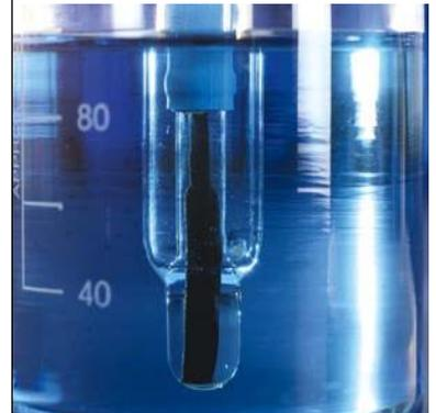
Al conectar cualquier sensor In-Lab ISM (Intelligent Sensor Management), el instrumento lo detecta automáticamente y guarda el ID del sensor, su número de serie y los datos de calibración más recientes.
