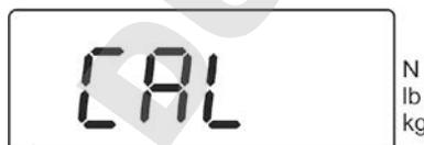
⇒ Attendre jusqu'à ce que la valeur du poids du poids d'ajustage nécessaire p. ex. 10 kg (voir au chap. 1) soit affichée.
