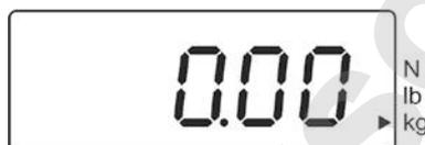
⇒ Mettre en marche le balance suspendue avec aide de suspension accrochée. Appeler et maintenir la touche **Unit** enclenchée (pendant env. 3 sec) jusqu'à ce que „CAL“ apparaisse.
