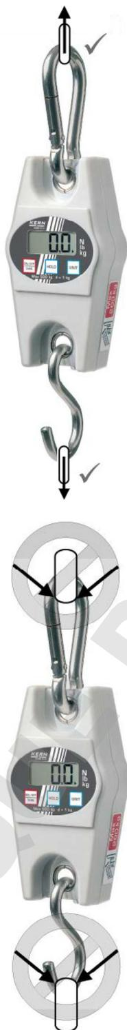
N'utilisez que du matériel d'élingage, qui garantisse une fixation à 1 point à laquelle la balance peut être suspendue librement.
