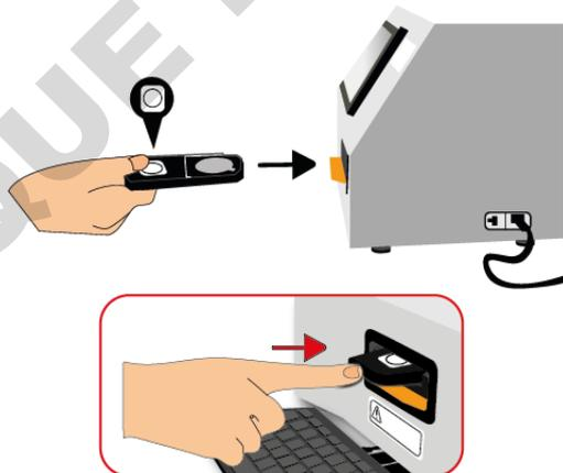
Lorsque le scan de la cassette est terminé, la porte s'ouvre et la cassette se présente. Une simple pression sur la face avant de la cassette permet de l'extraire.
