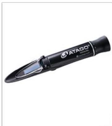
Cet instrument est conçu pour contrôler la concentration de l'eau salée, que ce soit pour la cuisine ou le rinçage des fruits de mer, et fait appel à un nouveau matériau résistant aux échantillons salés et acides. Le MASTER-S10M est une excellente alternative lorsque la caractéristique de résistance à l'eau n'est pas une priorité et que la Compensation de température va être effectuée manuellement.
