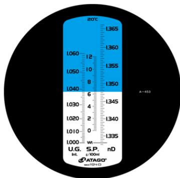
Le MASTER-SUR/N $\alpha$  est disponible pour les trois mesures cliniques : la protéine sérique, la gravité spécifique de l'urine et l'indice de réfraction. Ce boîtier en plastique a été conçu pour résister aux échantillons salés et acides. C'est un modèle avec des caractéristiques : compensation automatique de la température et résistance à l'eau (IP65).
