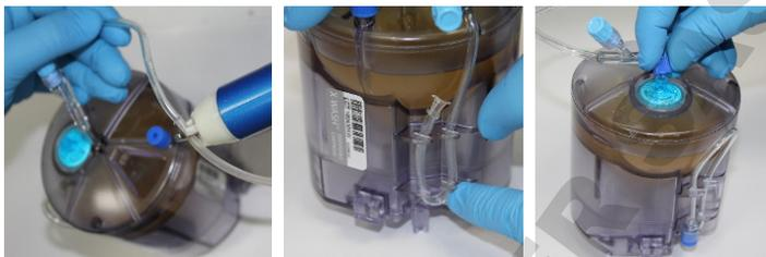
28. Fixez la cartouche jetable sur son support sur l'agitateur X-Mixer et appuyez sur le bouton « Continuous » pour commencer le cycle de mélange. Réglez un minuteur sur 30 secondes. Au bout de 30 secondes, arrêtez le X-Mixer en appuyant sur n'importe quel bouton. Une fois la cartouche jetable revenue en position verticale et non plus en mouvement, détachez la cartouche jetable du support de cartouche jetable et fixez la cartouche jetable au module de contrôle.
