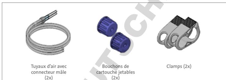
La **tubulure d'air avec connecteur mâle** se fixe au filtre à air de la cartouche jetable et à une pompe péristaltique pour faciliter le transfert de liquide dans et hors de la cartouche jetable.
