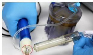
5. Reliez le sac de milieu à la cartouche jetable par soudage stérile sur la ligne d'entrée ou par le biais du port sans aiguille. Placez un clamp sur le sac de milieu pour éviter tout débordement de liquide.
