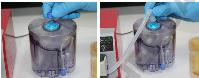
25. Vérifier que l'affichage de la pompe indique 200 rpm. Appuyez sur le bouton de direction pour allumer le témoin de la flèche dans le sens inverse des aiguilles d'une montre.
