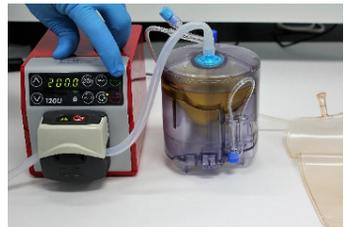
17. Arrêtez la pompe lorsque le transfert des déchets est terminé dans le sac à déchets ou lorsque l'air commence à pénétrer dans le sac à déchets en appuyant sur le bouton STOP sur la pompe. Clampez la conduite d'entrée en appuyant sur le bouton STOP sur la pompe. Clampez la conduite d'entrée pour éviter tout mouvement du liquide entre la cartouche jetable et le sac. Détachez la tubulure d'air de la cartouche jetable.
