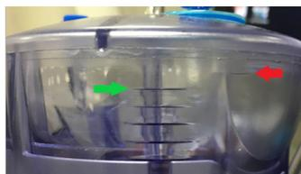
27. Détachez le sac de milieu en obturant la conduite d'entrée près de la soudure ou en retirant le sac du port sans aiguille. Libérez le clamp. Réinsérez la tubulure dans les clips latéraux de la cartouche jetable. Replacez le bouchon du filtre à air de la cartouche jetable.
