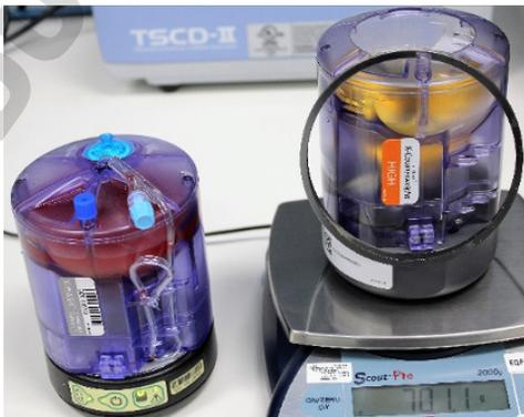
6. Si nécessaire, placez des anneaux d'équilibrage à l'intérieur du bord du godet de centrifugation avec l'ensemble cartouche jetable/module de contrôle.
