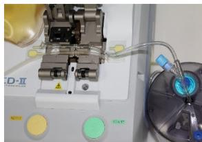
24. Transportez la cartouche jetable et le sac de milieu vers la pompe péristaltique, vérifiez que bouchon du filtre à air est retiré, puis fixez la tubulure d'air de la pompe péristaltique au filtre situé sur le couvercle de la cartouche jetable. Assurez-vous que la tubulure d'air ne soit pas pincée. Assurez-vous que la cartouche jetable reste verticale tout au long de ce processus.
