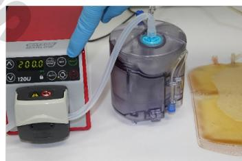
26. Mesurer le volume estimé de la chambre centrale à l'aide des 4 lignes sur le côté de la cartouche jetable, en remplissant jusqu'à 220 mL (en haut des 4 lignes, repérés d'une flèche verte). Arrêtez la pompe lorsque le milieu est totalement transféré dans la cartouche jetable. Clampez la conduite d'entrée pour éviter tout mouvement du liquide entre la cartouche jetable et le sac. Détachez la tubulure d'air de la cartouche jetable.
