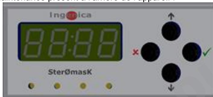
A l'arrêt, l'afficheur est éteint. Un appui sur un bouton active la sélection du menu.
