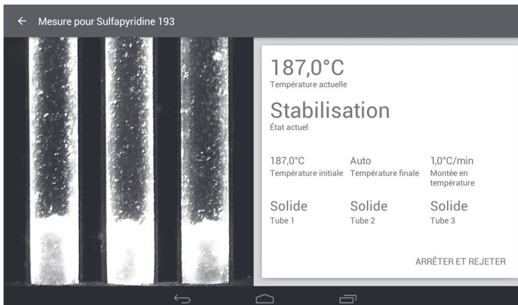
Écran d'exécution indiquant l'état « Stabilisation »
