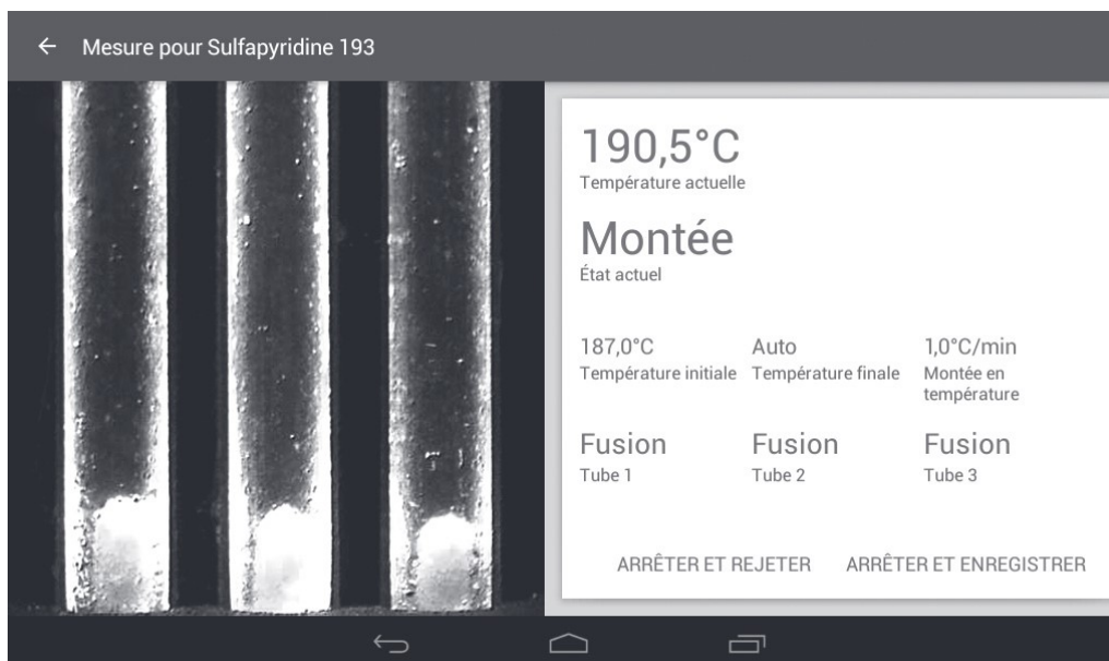
Écran d'exécution indiquant l'état d'échantillon « Fusion » pour les trois tubes capillaires
