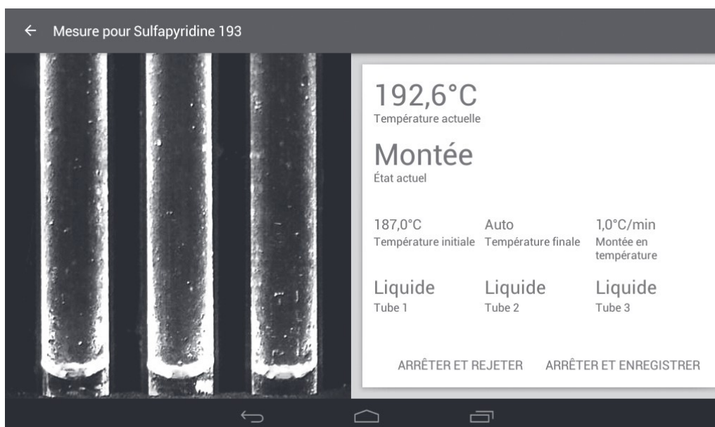
Écran d'exécution indiquant l'état d'échantillon « Liquide » pour les trois tubes capillaires
