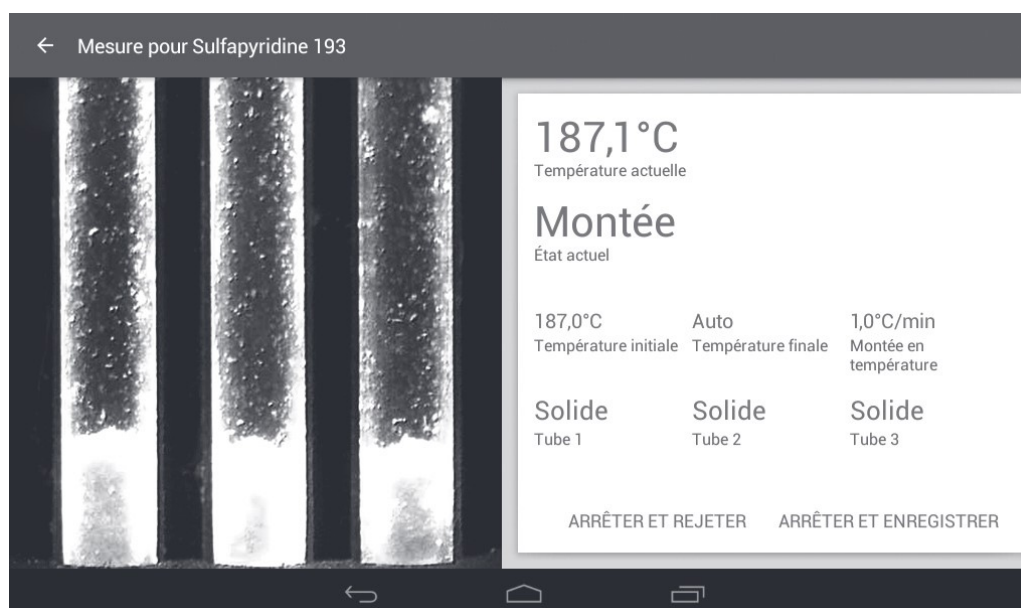
Écran d'exécution indiquant l'état « Montée »
