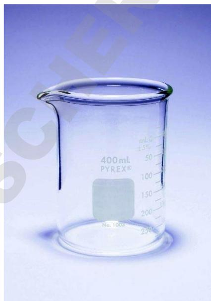
Les parois plus épaisses des béchers à usage intensif Pyrex\* impliquent qu'il faut être particulièrement vigilant lors du chauffage et du refroidissement.
