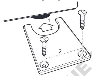
Vergewissern Sie sich, dass das Gerät richtig aufgestellt ist. Schieben Sie die Fixierungen jeweils von der Seite des Geräts um einen der hinteren Standfüße (1). Befestigen Sie die Fixierung mit 2 Schrauben (8 x 20 mm) (2).
