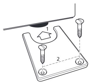
Asegúrese de que la unidad esté colocada correctamente. Desde los laterales de la unidad, deslice las abrazaderas en torno a cada una de las patas traseras (1). Fíjelas en su lugar con dos tornillos nº 8 de 20 mm (2).
