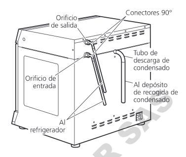
Se obtendrá un rendimiento óptimo con el tubo de conexión lo más corto posible. Tenga en cuenta las especificaciones del refrigerador para las longitudes aceptables de los tubos y la altura máxima del cabezal. Coloque el refrigerador en una posición segura para evitar una colisión accidental.
