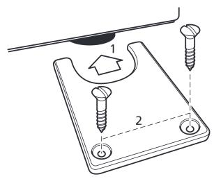
S'assurer que l'appareil est positionné correctement. Depuis les côtés de l'appareil, faire glisser les supports de pieds autour de chacun des pieds arrière (1). Les fixer en place à l'aide des deux vis n° 8 x 20 mm (2).
