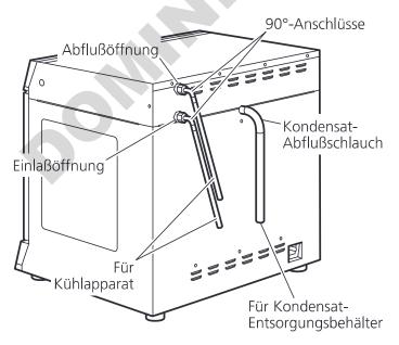
sich der Kühlapparat auf einer festen Oberfläche befindet und nicht vibriert, wenn der Inkubator mit maximaler Drehzahl (U/Min) arbeitet. Verbinden Sie die Kondensatschläuche mit dem Kondensatablassrohr und das andere Ende mit einem Abwasserauffangbehälter, der tiefer liegt als das Kondensatablassrohr. Vergewissern Sie sich, dass der Abfallentsorgungsbehälter ein Flüssigvolumen halten kann, das so groß wie das Volumen des Kühlmittels des Kühlapparats ist.
