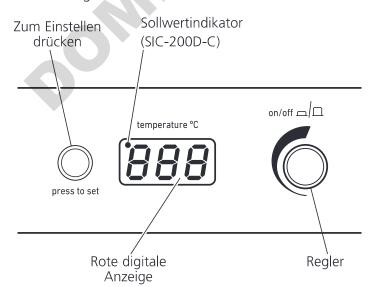
Lassen Sie die Taste "press to set button" los. Der Inkubator beginnt dann mit der Erhitzung bis zur eingestellten Temperatur. Die tatsächliche Innentemperatur des Geräts wird auf dem Bildschirm angezeigt. Die minimal eingestellte Umgebungstemperatur ist +5°C (Mindestumgebungstemperatur -15°C oder 5°C bei SIC-200D-C) und die Maximaltemperatur beträgt 60°C.
