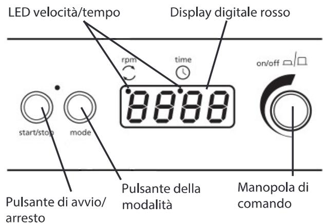
13. Mantenere premuto il pulsante "mode" ("modalità") finché sul display non compare un punto rosso al di sotto di "rpm" ("giri/min"). Sul display verrà visualizzata l'ultima velocità impostata.
