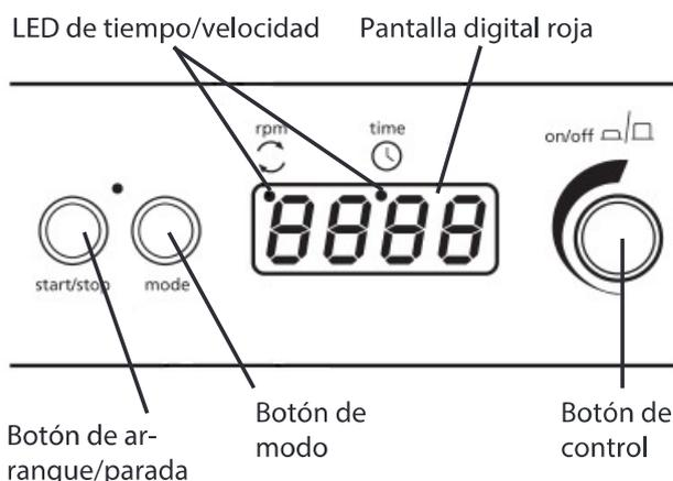
13. Pulse el botón "mode" (modo) hasta que aparezca un punto rojo en la pantalla debajo de "rpm". La pantalla mostrará la velocidad que se fijó por última vez.
